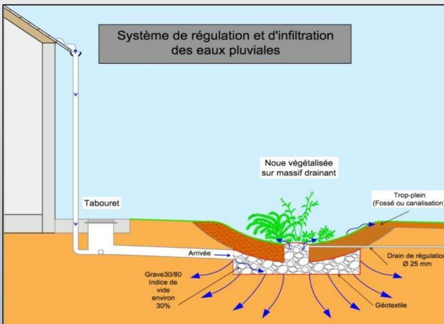
La figure ci-contre présente le schéma d'un jardin de pluie, dispositif permettant de coupler l'infiltration (infiltration des eaux pluviales les plus courantes au droit du massif de grave) et la rétention des eaux pluviales (stockage des eaux pluviales au droit de la noue de rétention et régulation des eaux pluviales du fait de la mise en œuvre d'un orifice de régulation).
